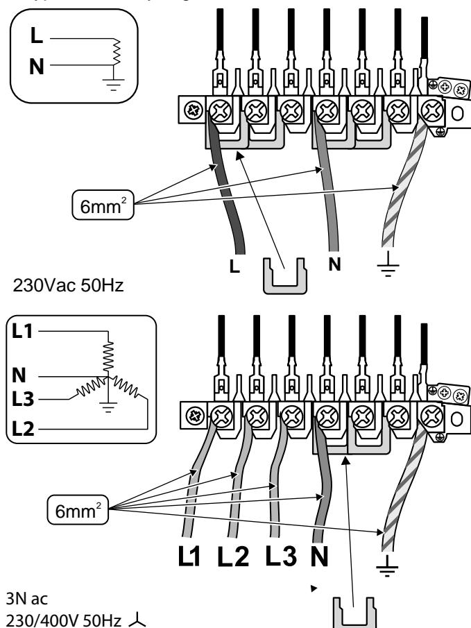
Sjekk at forbindelsene er montert korrekt og at tilkoblings-skruene er fast tiltrukket. Sikre nettkablen med bruk av kabelklammen.
