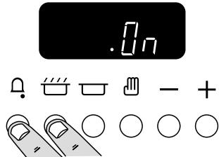
Hold stoppeklokkebryteren [⌚] og tilberedningstidbryteren [⌚] i omtrent 8 sekunder. 'On' ('På') vil vise seg i displayet.
