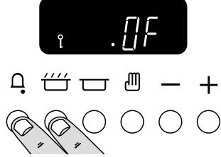
Hold stoppeklokkebryteren [⌚] og tilberedningstidbryteren [⌚] i omtrent 8 sekunder. 'Of' ('Av') vil vise seg i displayet.
