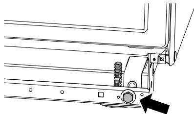
De forreste fodder kan indstilles ved at dreje den nedre del for at hæve eller sænke.
