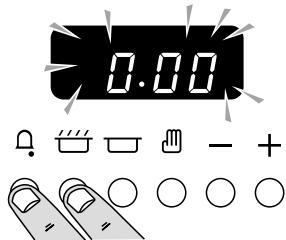
Hold nede som vist. På samme tid trykkes på (-) eller (+), indtil det korrekte klokkeslæt vises. Husk, at det er et 24 timers ur. Hvis du laver en fejl, eller trykker på den forkerte knap, skal du slukke for strømmen i et eller to minutter, og begyndte igen.
