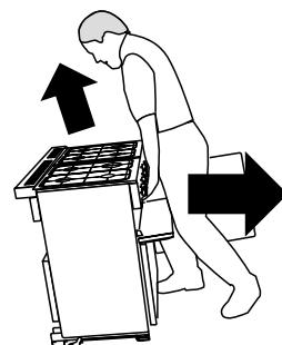
Flytt ovnen et lite stykke om gangen, og sjekk på baksiden for å forsikre deg om at ikke gassledningen sitter fast i noe. Forsikre deg om at både elektrisitets- og gasskablene er slakke nok til at komfyren kan flyttes fremover.
