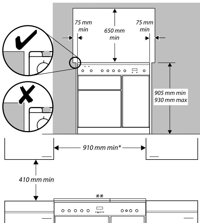
Kogefeltet skal være på niveau med eller højere end tilstødende arbejdsflader. Over kogefeltet skal der være en afstand på 7,5 cm mellem hver side af komfuret og tilstødende lodrette flader.
