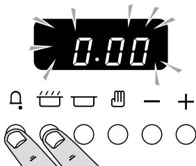
Trykk inn og hold som vist. Samtidig trykker du på (-) eller (+) inntil det vises korrekt klokkeslett. Glem ikke at det er et 24-timers ur. Hvis du gjør feil eller trykker på feil knapp, slå av strømtilførselen i et minutt eller to og begynn på nytt.
