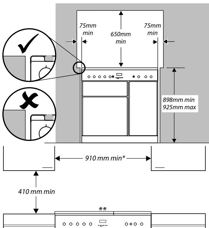
Kokeplatens innfatning skal være på nivå med, eller ovenfor, eventuell kjøkkenbenk ved siden av. Over kokeplatens nivå skal det være en avstand på 75mm mellom hver side av komfyren og en eventuell vertikal overflate ved siden av.
