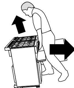
Flyt komfuret lidt ad gangen, og check bag den så du kan sikre dig, at gasslangen ikke kommer i klemme. Sørg for, at både el- og gaskablerne er lange nok til at flytte komfuren fremad efterhånden.
